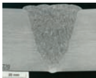
Макро сечение толщины стенки от 49 мм S 31803; дуплексная труба из нержавеющей стали – сварка при строительстве оффшорных объектов.
