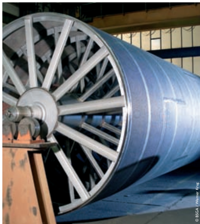
Обезвоживающий барабан для целлюлозно-бумажной промышленности, Andritz AG. Сварка с использованием BÖHLER CN 22/9 N-IG (ДСНЭ) и BÖHLER CN 22/9 N-FD (ДСПП).
