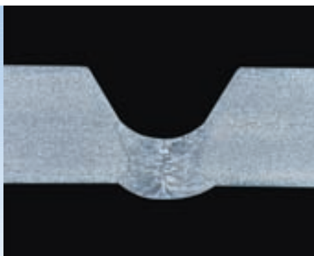
Порошковая проволока \varnothing 1,2 мм Хорошее проплавление корневого слоя и смачиваемость; очень высокая производительность при использовании керамических подкладок.
